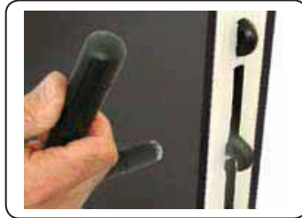
Schnelles und genaues Setup dank exzentrischen Spannschlössern. Die Zelle ist daher, im Falle von Betriebsverlagerungen, leicht zu zerlegen und wieder aufzubauen.
